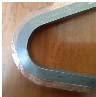
Рис. 8. Згин зразка через призму R = 3 mm на кут 150°.
