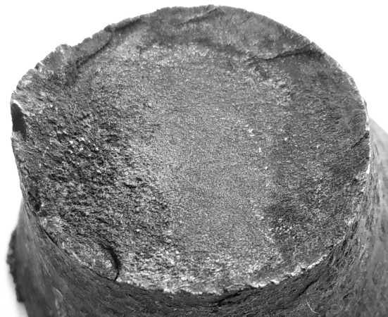
Рис. 2. Втомний злам штанги зі сталі 20H2M.
