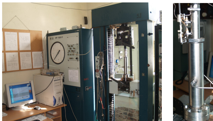
Рис. 2. Установка з камерою для випробувань зразків розтяганням у водні.
