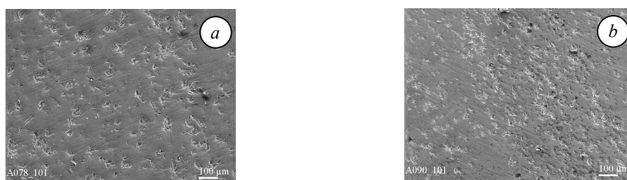
Рис. 6. Поверхня шліфа сплаву \text{ZrMn}_{0,5}\text{Ni}_{1,2}\text{Cr}_{0,2}\text{V}_{0,1} без витримки ( a , x100, SEI) і з витримкою на повітрі протягом 15 діб ( b , x100, SEI) із наступною витримкою у розчині КОН протягом 7 діб.
