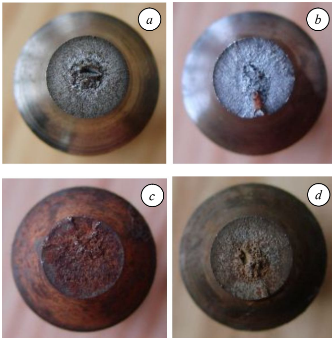
Рис. 2. Втомні злами зразків на повітрі та в корозивному середовищі: контрольний (а, с), витриманий у гідраті (б, д), 340 МПа.
